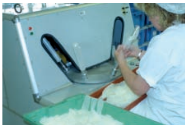
Abb. 7: Im Hochspannungsfeld wird jede einzelne Hülle geprüft.
