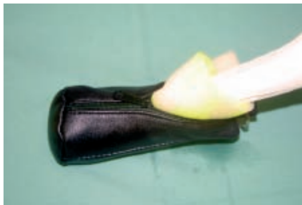
Abb. 5: Vaginadummy zur Lochdurchdringungstestung mit fluoreszierendem Farbstoff.
